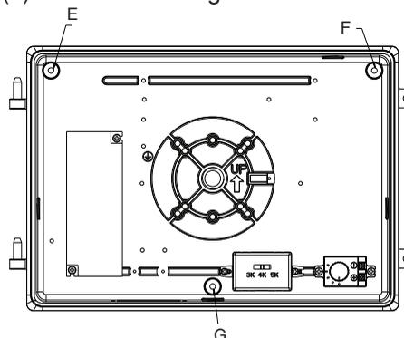
3. Faites passer les fils d'alimentation à travers le trou d'entrée du câble dont le bouchon a été enlevé à l'étape 2. Connectez l'alimentation principale au pilote en conformité avec le schéma de câblage.
