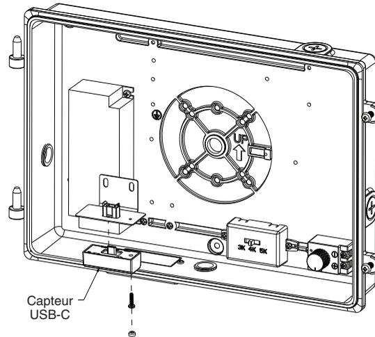
3. Mettez la plaque d'installation dans sa position originale et fixez avec les deux (2) vis enlevées pendant l'étape 1. Le capteur doit rentrer dans la lentille en plastique dans la partie inférieure du luminaire.
