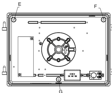
5. Remettez le réflecteur sur la plaque arrière à l'aide du mécanisme à charnière. Connectez l'alimentation principale au pilote en conformité avec le schéma de câblage. Ensuite, branchez les connecteurs mâle et femelle. Finalement, utilisez un tournevis adéquat pour connecter le réflecteur à la plaque arrière pour étanchéiser le luminaire.
